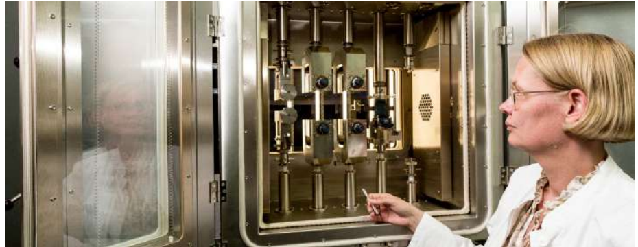
Dr. Esther van Dorp an der Kriechprüfmaschine Kappa
