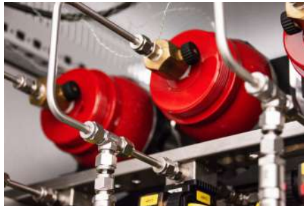
Metallhydridspeicher im Inneren
