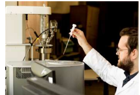
René Burger analysiert Lignine mittels 1H Benchtop-NMR-Spektroskopie
